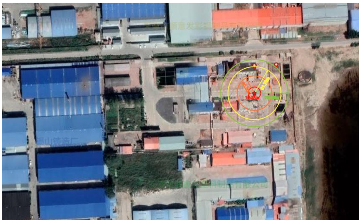
图 6.2-15 甲苯水溶液中间罐泄漏到大气中-大孔泄漏蒸气云爆炸事故后果模拟图
